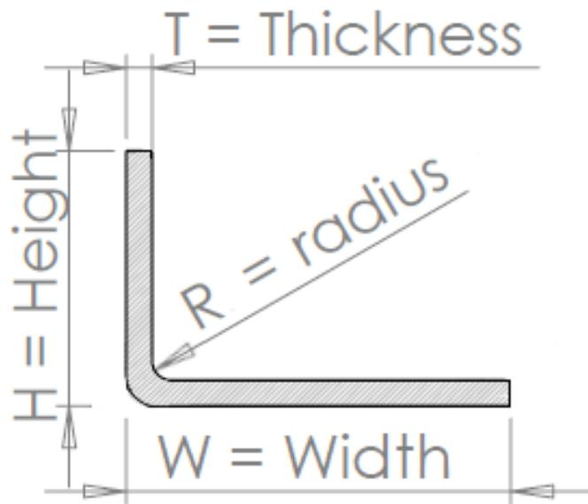
**Fig. 18: Bent L-beam**
