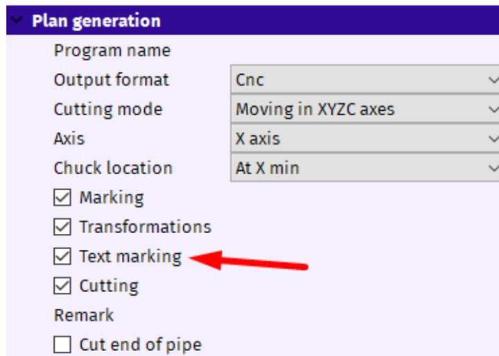
**Fig. 191: Text marking generation – enabled**
