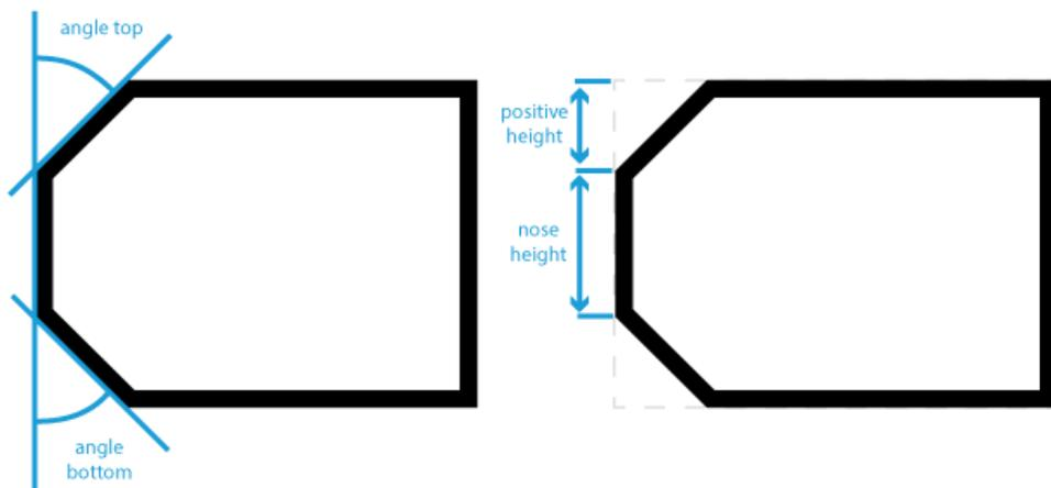
**Fig. 203: Weld preparation parameters**
