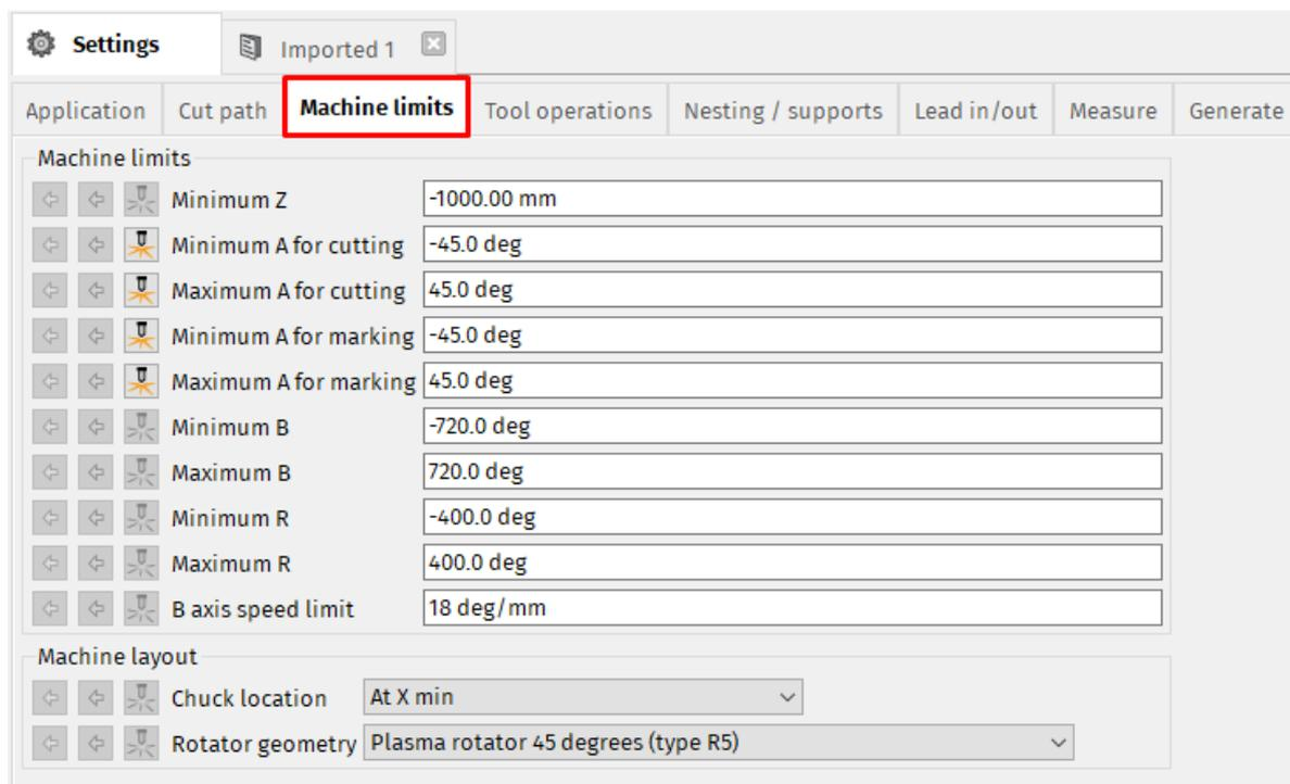
**Fig. 310: Machine limits**
